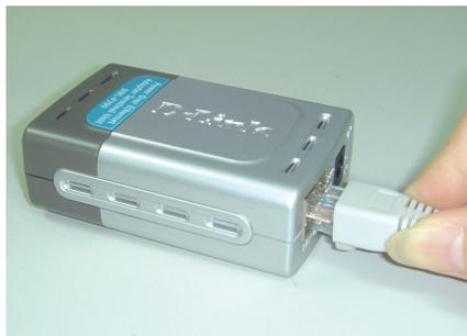
Insérez une extrémité du câble d’alimentation DC fourni dans l’Unité terminale, et l’autre extrémité dans le connecteur DC de l’équipement réseau. Le témoin vert d’alimentation “PWR” de l’Unité de base s’allume.
