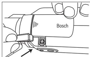
**Figure 5.8** Connecteur pour objectif
