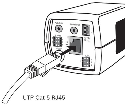
**Figure 5.1** Connexion réseau
