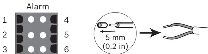
**Figure 5.3** Broches des connecteurs d'alarme et de relais
