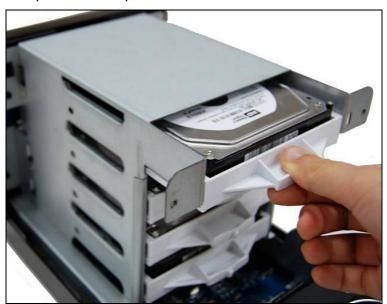
6. Si vous utilisez des disques durs de 3,5 po. sécurisez les intercalaires de disque dur avec des vis (de fixation des intercalaires de disque dur) fournies.
