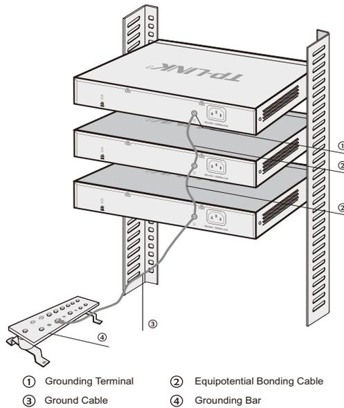
Figure 3-3 Equipotential Bonding
