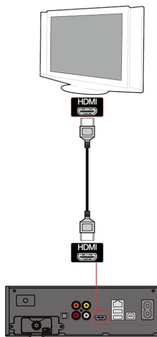
Connectez le TVX-HD à votre TV en utilisant le câble HDMI. Le TVX-HD joue les vidéos HD (jusqu'à 1920x1080i) par le câble HDMI. Le câble HDMI transmet les signaux audio et vidéo non compressés. Aucun câble additionnel n'est nécessaire.
