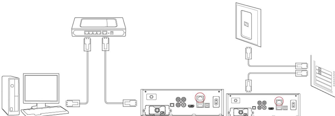
Connectez le câble réseau au port réseau du TVX-HD et du routeur IP or Hub.
