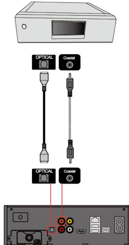
Si vous avez un amplificateur/décodeur multi canal ayant une entrée optique, vous pouvez profiter de la haute qualité du son en 5.1 avec le câble optique. La figure ci-dessus vous montre comment connectez le câble optique (ce câble optique n'est pas fourni est doit être acheté séparément) avec le jack optique (fourni).
