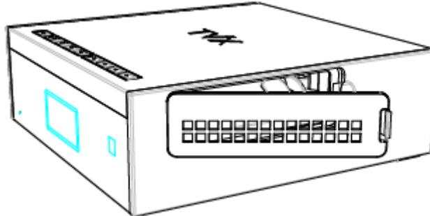
**6** Pour retirer le disque dur, tirez le guide du disque dur tout en appuyant sur le bouton de verrouillage.
