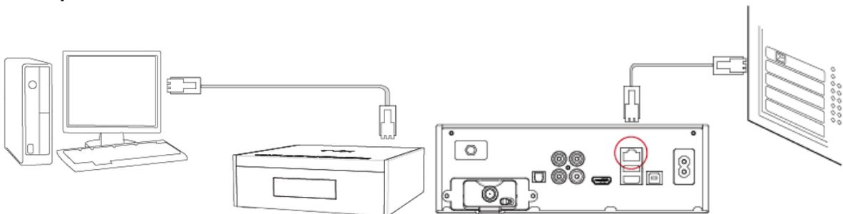
Connectez le câble réseau au port réseau du TVX-HD et du PC.
