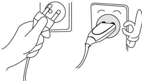
Ne pas brancher le câble électrique d'alimentation avec des mains mouillées ou ne pas utiliser un câble ou prise défectueux. Cela peut provoquer une électrocution ou un incendie.
