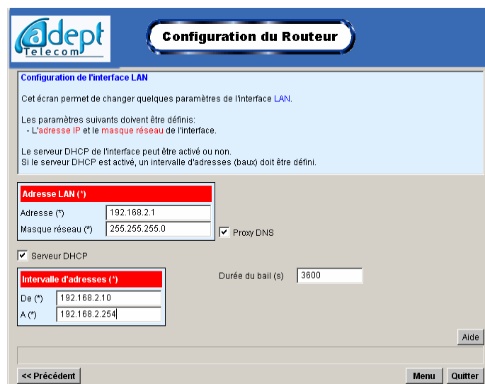
Figure 26-9 : configuration du réseau local du télé-travailleur
