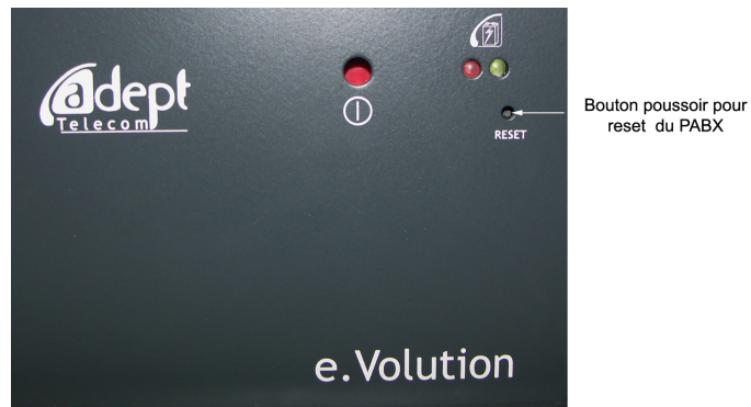
Figure 7-2 : Bouton poussoir pour reconfiguration du PABX
