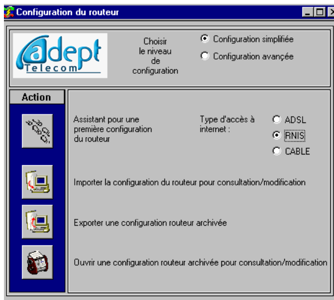
Figure 14-3 : Fenêtre de configuration des routeurs (en mode Utilisateur)
