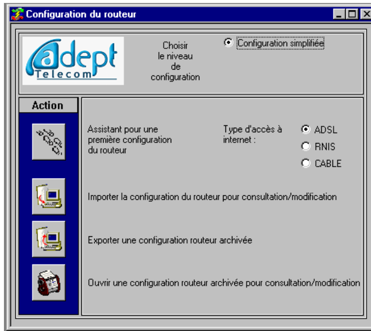
Figure 14-2 : Fenêtre de configuration des routeurs (en mode Utilisateur)
