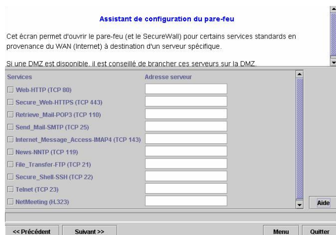
Figure 14-40 : Configuration étendue du pare-feu
