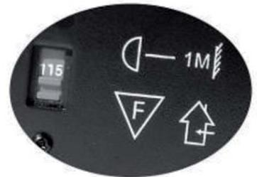
Attention : si votre appareil en est équipé, assurez vous que l'interrupteur pour sélectionner le voltage correspond bien à votre installation. Toute installation électrique doit être reliée à la terre.
