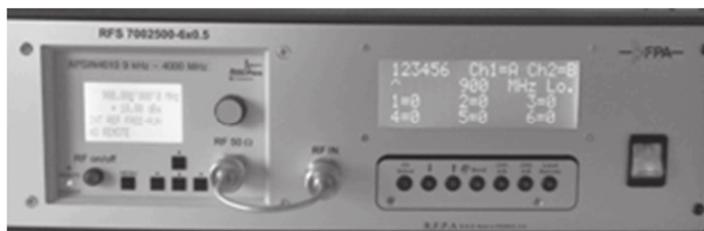
Figure 2 : photo du générateur radiofréquence et commutateur d'antennes (module RFA).
