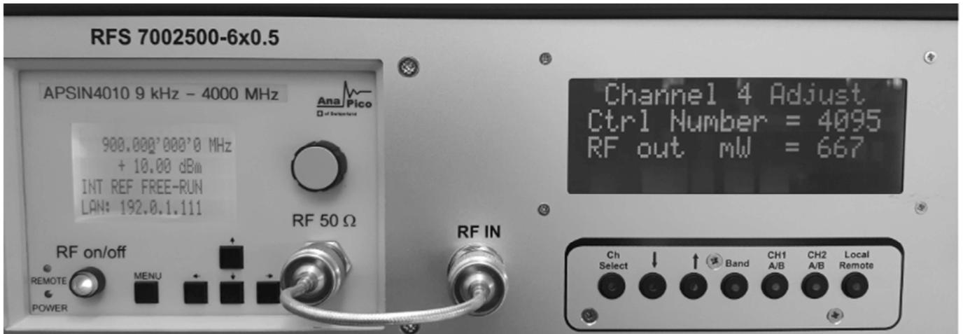
Figure 2 : générateur sinusoïdal et son atténuateur.
