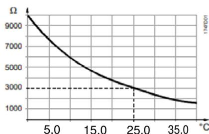
Cette sonde mesure la température ambiante à l'aide d'une thermistance CTN. La valeur ohmique varie en fonction de la température ambiante. Les valeurs mesurées sont fournies à un régulateur approprié.
