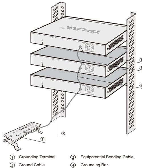
Figure 3-3 Equipotential Bonding
