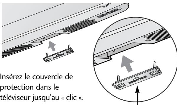
Insérez le couvercle de protection dans le téléviseur jusqu'au « clic ».
