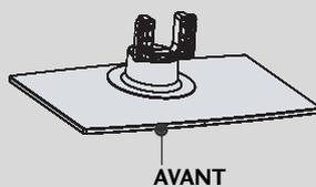
Lorsque vous assemblez le socle, veillez à bien distinguer la partie avant et arrière du socle de sorte à le monter correctement.
