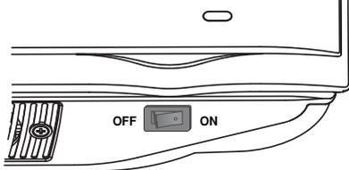
**Commutateur de mise sous tension**
