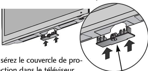
Insérez le couvercle de protection dans le téléviseur jusqu'au « clic ».
