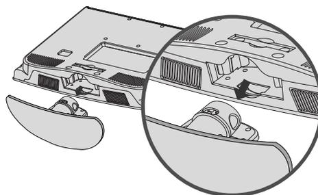
**4** Insérez le cache de protection dans le téléviseur.
