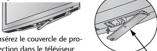
Insérez le couvercle de protection dans le téléviseur jusqu'au « clic ».
