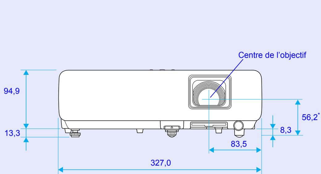
\* Distance entre le centre de l'objectif et le trou de montage pour bride de suspension
