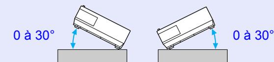
Si vous inclinez le projecteur de plus de 30°, il risque de tomber et d'être endommagé ou de provoquer un accident.
